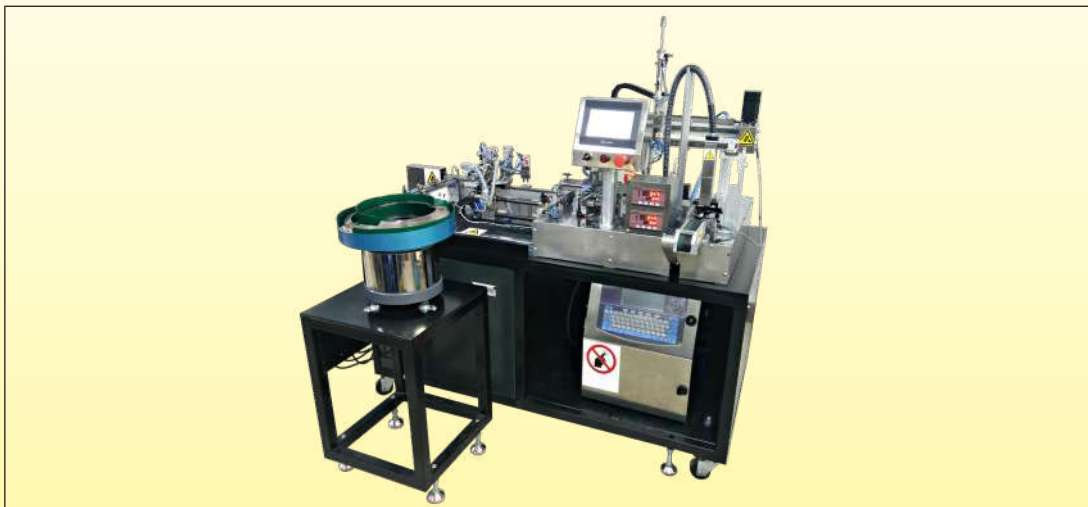
Pruebas automatizadas de la resistencia de la soldadura en producción a temperatura ambiente
