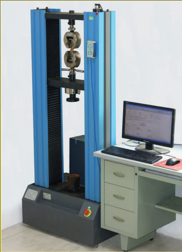
Equipo de resistencia a la tracción y elongación en la rotura
